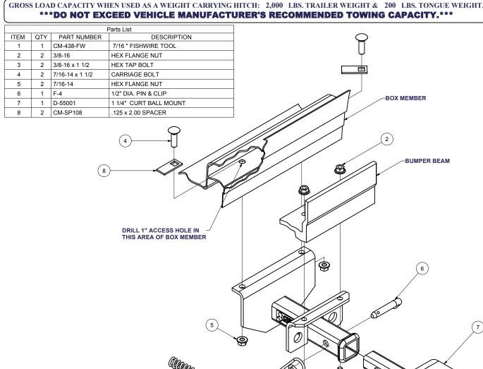
HITCH WEIGHT: <u>11</u> LBS. INSTALL TIME: <u>30</u> MINUTES INSTALL NOTES: DRILLING REQUIRED FASCIA TRIMMING REQUIRED
